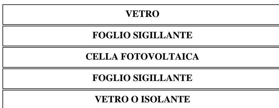
Figura 3: STRATI CHE COMPONGONO UN MODULO FOTOVOLTAICO
