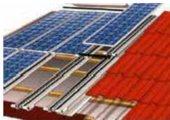
Figura 12 : INTEGRATO SU TETTO E/O EDIFICIO
